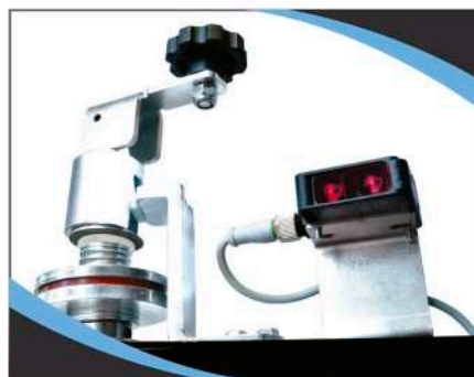
Sensor fotocélula para detectar cargas oscuras.
