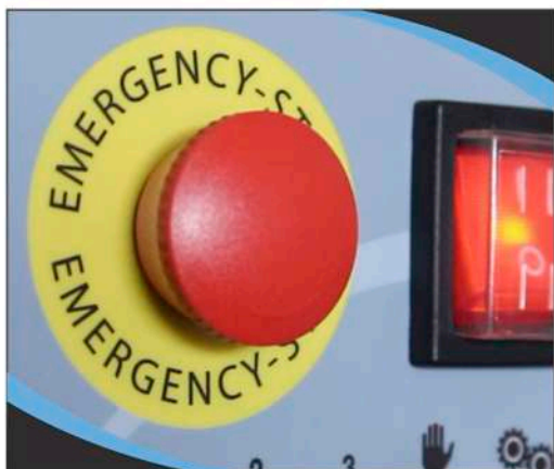
Botón de emergencias. Al accionarlo la máquina se detiene al instante.
